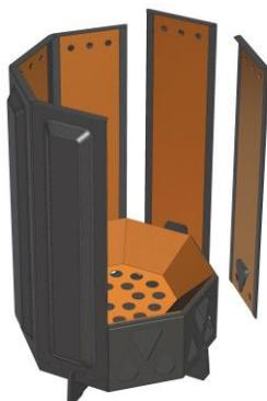
パネル下部の三角の突起をトレー側面の穴に引掛けるように差し込んで取り付けてください。
